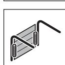
Направляющая с пружинами растяжения
